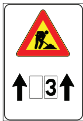
Fig. 4590 segnale fisso di preavviso ad inizio tratta
